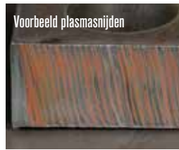
Vergelijking snijnsnelheid op 12 mm koolstofstaal
